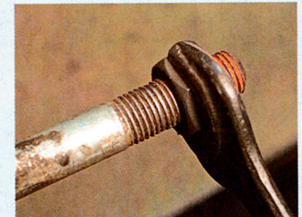
Einfache Anwendung: die leicht eingeeölte Nachschneidmutter
