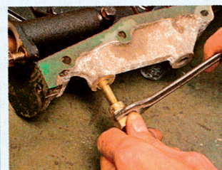
Der Nachschneidbolzen korrigiert leichte Schäden in Innengewinden
