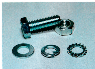
Von begrenzter Wirkung: Unterleg-, Feder- und Zahnscheiben (v. l.)
